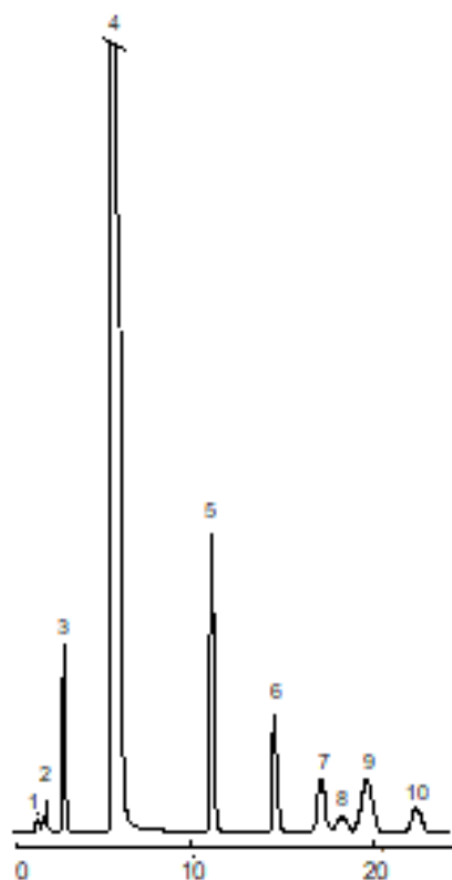
1 – воздух; 2 – метан; 3 – этан + этилен; 4 – пропан; 5 – изобутан; 6 – н-бутан; 7 – бутен-1; 8 – изобутен; 9 – транс -бутен-2; 10 – цис -бутен-2
